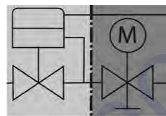
Рис. 33 Функциональная схема работы клапана БРОЕН Dynamic с установленным электроприводом
