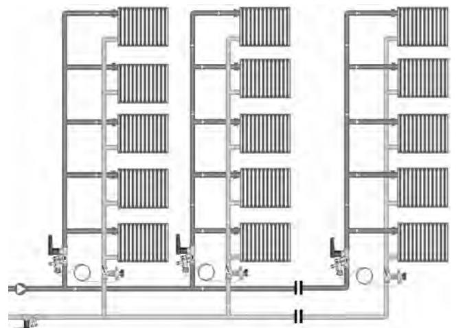
Клапан БРОЕН DP совместно с клапаном БРОЕН Venturi устанавливаемым на подающей трубе в качестве клапана партнера могут выполнять функции как регулятора перепада давления, так и ограничителя расхода обеспечивая заданные их характеристики на каждом циркуляционном кольце и потребителе, что широко используется в радиаторных системах отопления с преднастроенными терmostатическими клапанами.
