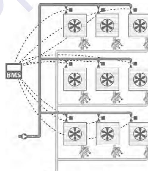
Рис. 46 Установка клапана БРОЕН Dynamic на обвязке фанкойла
