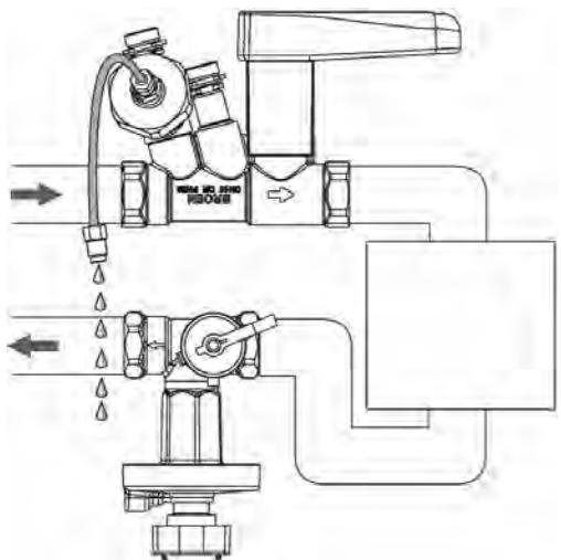
4. Капиллярная трубка сначала устанавливается на клапане со стороны подающей трубы (БРОЕН Venturi) и перед установкой на второй клапан, через нее производится слияние для того чтобы убедиться что в ней не осталось воздуха.
