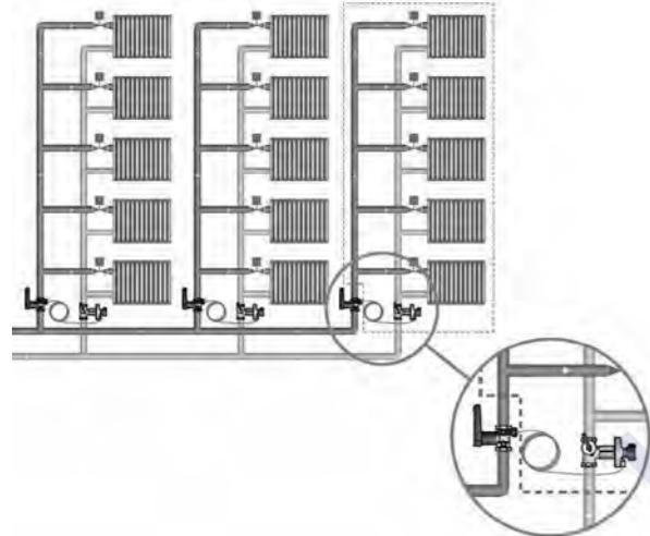
Пример 3. Применение запорных клапанов БРОЕН Basic в составе однотрубной системы отопления
