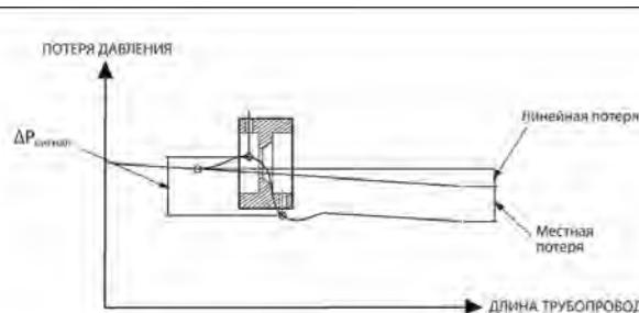
Рис. 9 График потери давления на седле клапана седельчатой конструкции
