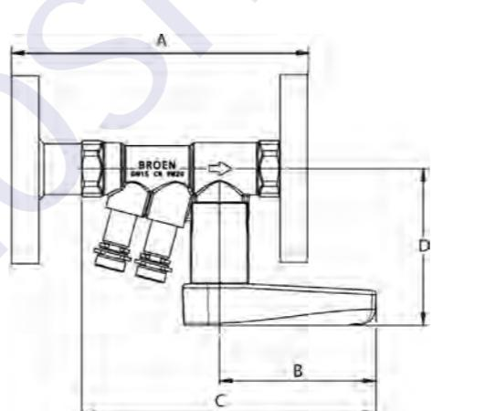
Рис. 18 Клапан БРОЕН Venturi FODRV DN 015-050 фланцевый
