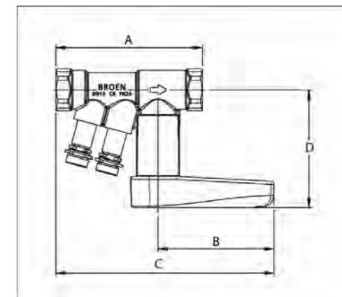
Рис. 57 БРОЕН Venturi
