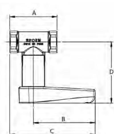
Рис. 17 Клапан БРОЕН Venturi DRV DN15-050 муфтовый
