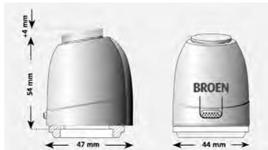
В механизме привода используется резистор, меняющий линейный размер при подаче напряжения питания. Линейная деформация резистора приводит к изменению положения регулировочного штока привода. Запаздывание и задержка регулирования являются следствием инерционности нагрева и охлаждения резистора. Зависимость хода штока от управляющего сигнала во времени приведена на графике.
