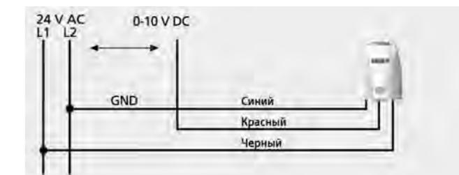
Рис. 51 Схема подключения привода
