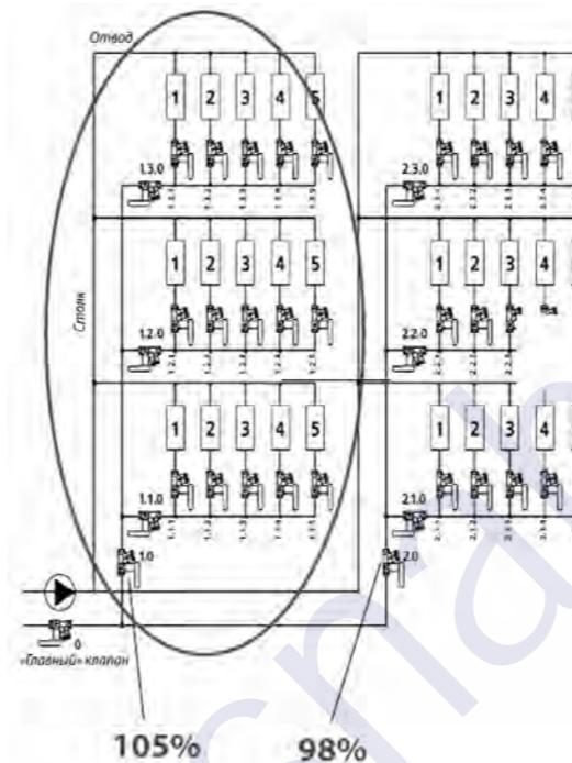
**Примечание:** Если наибольшее значение  $\lambda$  клапанов на стояках превышает 110%, следует его ограничить до 110% перед продолжением увязки отводов данного стояка.
