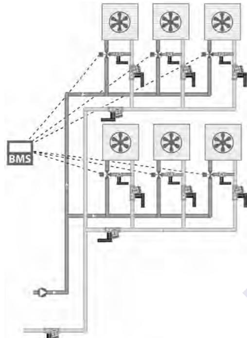
В составе водосмесительного узла для подключения фанкойла клапан БРОЕН Venturi DRV может быть установлен на байпасной линии для настройки коэффициента смешения трехходового регулирующего клапана.
