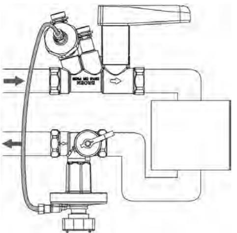
5. Капиллярная трубка монтируется на клапан БРОЕН DP. После этого DP контроллер готов к работе.
