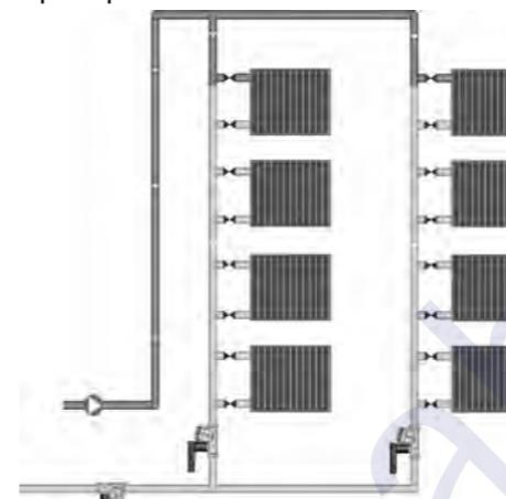
В однотрубной системе отопления с байпасной линией клапан БРОЕН Venturi FODRV может работать в качестве ручного ограничителя расхода для проведения гидравлической увязки.
