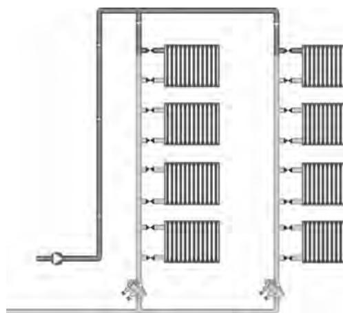
Рис. 47 Установка клапана БРОЕН Dynamic на стояке системы отопления
