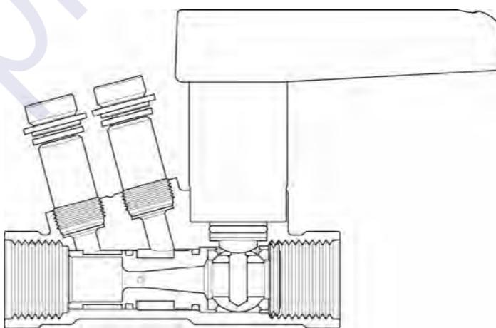
Рис. 6 Конструкция клапана БРОЕН Venturi FODRV
