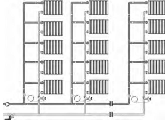
В зависимости от применения, клапан БРОЕН DP может быть использован либо в качестве клапана зональной регулировки, размещенного на магистральных участках системы, для поддержания постоянного перепада давления между различными группами потребителей или в качестве клапана терминальной регулировки, для обеспечения необходимого перепада давления на каждом потребителе при любых нагрузках.
