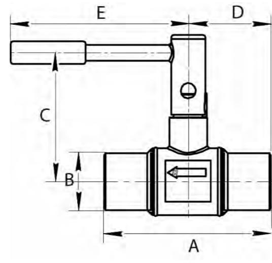
Рис. 23 Клапан БРОЕН Venturi DRV DN 065-200
