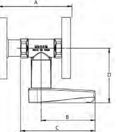
Рис. 19 Клапан БРОЕН Venturi DRV DN 01
