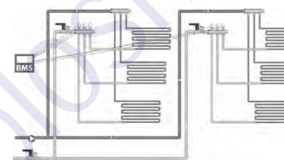
В системе отопления типа «теплый пол» клапан БРОЕН Venturi FODRV работает в качестве ручного ограничителя расхода на потребителях для проведения гидравлической увязки.
