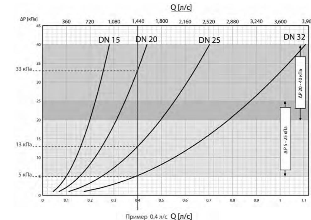
Рис. 62 Характеристика пропускной способности (Kv) клапана БРОЕН DP
