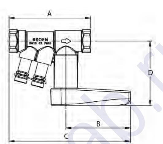
Рис. 16 Клапан БРОЕН Venturi FODRV DN15-050 муфтовый
