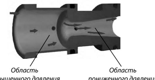
Рис. 8 Конструкция измерительной диафрагмы клапана БРОЕН Venturi
