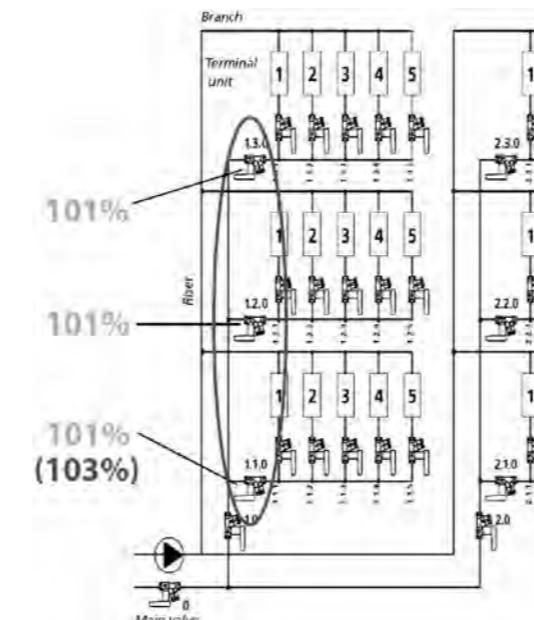
Затем второй расходомер подключаем к клапану 1.1.0. и приводим в соответствие друг другу значения  $\lambda$  для клапанов 1.3.0. и 1.1.0. Получаем:
