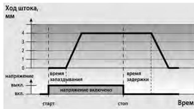
Новый клапан поставляется со штоком, расположенным в верхнем положении. Это сделано для того, чтобы после установки на клапан привод, будучи обесточенным, не прикрывал его при проведении пуско-наладочных работ в системе. Привод начнет функционировать в нормальном режиме спустя 6 минут после подачи питания, полностью закрыв клапан.
