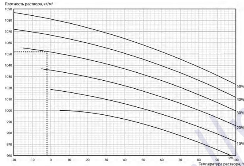
Рис. 63 Диаграмма зависимости плотности водного раствора этиленгликоля от температуры и концентрации
