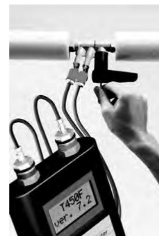
Рис. 7 Измерение расхода на клапане БРОЕН Venturi
